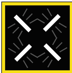
BLANCO TITILANTE Barrera bajando o falla de barrera. Acompaña el ritmo de las luces de barrera
